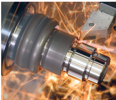
Tournage dur jusqu'à 65 ROCKWELL-HRC
