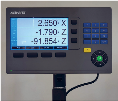
Visualisateur électronique pour les 3 axes
