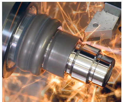
Tournage dur jusqu'à 65 ROCKWELL-HRC
