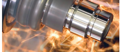
Tournage dur jusqu'à 65 ROCKWELL-HRC
