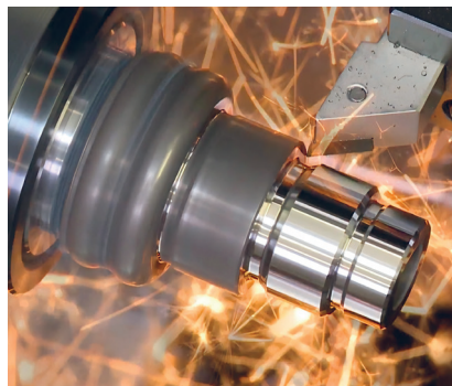
Tournage dur jusqu'à 65 ROCKWELL-HRC
