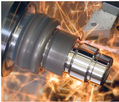
Tournage dur jusqu'à 65 ROCKWELL-HRC
