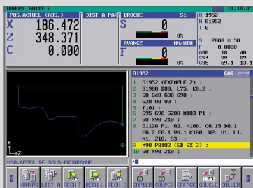
Mode Cycle: Ébauche/Finition Mode Zyklus: Schrappen/Schlichten Mode Cycle: Rough turning/Finishing
