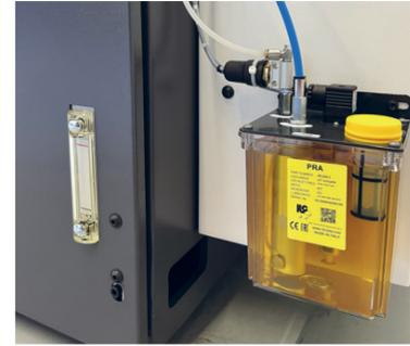
Dispositif de graissage automatique
