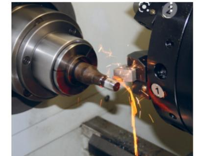
Eprouvée pour l'usinage de matériaux trempés
